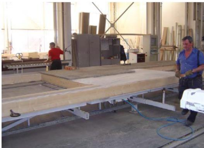
Fig. 18 – WeberHaus: fabrico dos componentes
